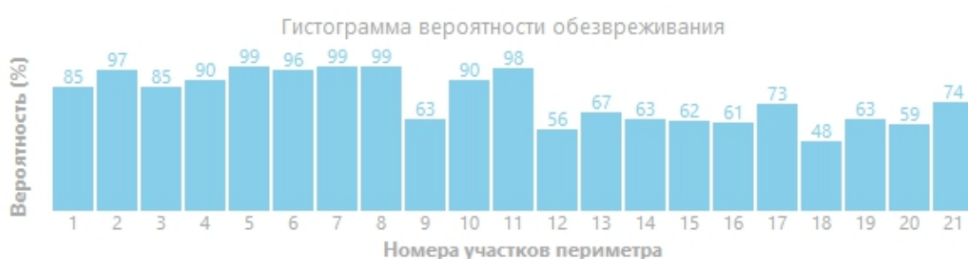
Рисунок 1 – Гистограмма распределения вдоль периметра вероятностей нейтрализации вандала, проникающего к железнодорожной эстакаде слива (модель М3.v1)
