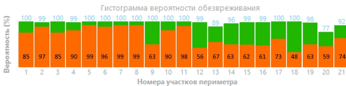
Рисунок 5 – Наложение гистограмм вероятностей обезвреживания нарушителя для системы до модификации (оранжевый – МЗ.v1: жд эстакада/вандал) и после модификации (зеленый)
