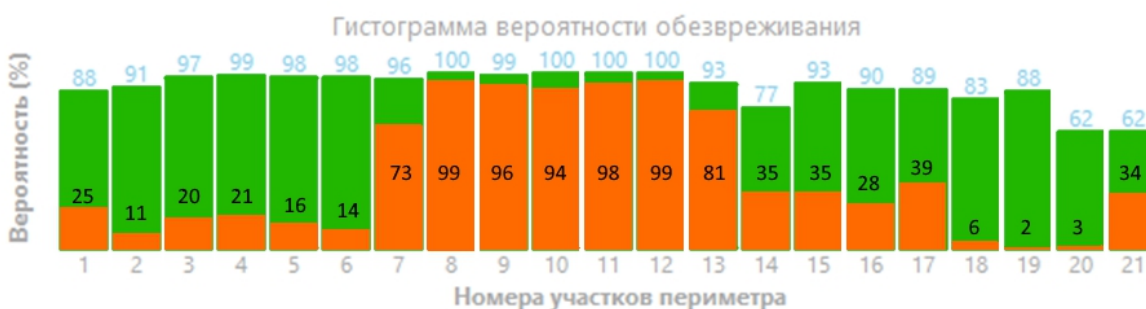
Рисунок 6 – Наложение гистограмм вероятностей обезвреживания нарушителя для системы до модификации (оранжевый – МЗ.v2: газовая котельная/вор) и после модификации (зеленый)
