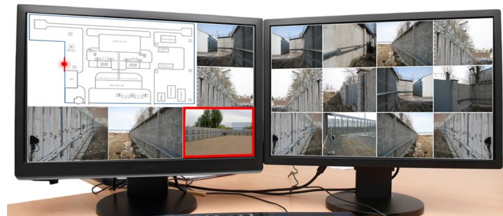
Рис. 16 Пример изображений с поворотных камер в интегрированной системе защиты периметра – на планах объекта показывается место возникновения тревоги
